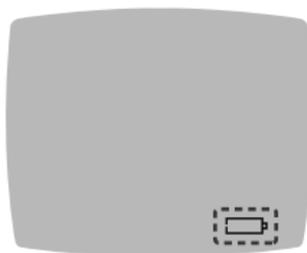
Wenn keine Messungen mehr möglich sind, zeigt das Messgerät den Bildschirm **Batterien leer** an. Wechseln Sie die Batterien unverzüglich aus.
