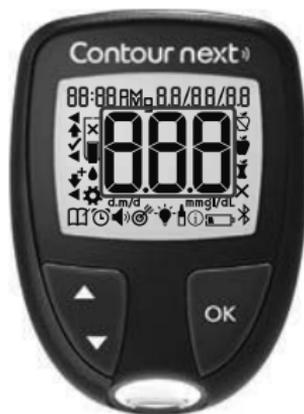
Alle Symbole auf der Anzeige sowie die weiße Sensoröffnung-Beleuchtung leuchten kurz auf. Achten Sie unbedingt darauf, dass das Messgerät die Ziffernfolge **8.8.8** vollständig anzeigt und das weiße Licht an der Sensoröffnung sichtbar ist.
