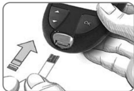
2. Stecken Sie das graue eckige Ende in die Sensoröffnung, bis das Messgerät einen Signalton ausgibt.
