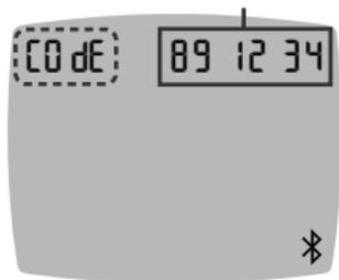
Sobald eine Verbindung hergestellt wird, zeigt das Messgerät einen 6-stelligen Code an.
