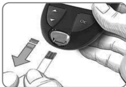
Um das Messgerät auszuschalten, entfernen Sie den Sensor.
