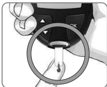
2. Führen Sie die Messöffnung des Sensors umgehend an den Blutstropfen. Das Blut wird durch die Messöffnung in den Sensor gesaugt.
