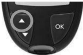
2. Drücken und HALTEN Sie 3 Sekunden lang die Taste ▲, bis Sie das blinkende **Bluetooth**-Symbol sehen (wie im nächsten Schritt gezeigt). Wenn sich das Gerät im Kopplungsmodus befindet, blinkt ein blaues Licht.
