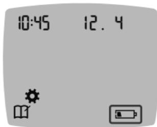
Wenn die Batterien nachlassen, funktioniert Ihr Messgerät weiterhin normal, zeigt aber das Symbol **Batterien schwach** an, bis Sie die Batterien auswechseln.
